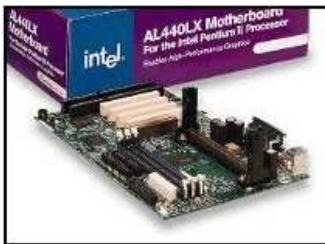
La placa central, también conocida por el término en inglés de "MOTHERBOARD", es *una tarjeta de circuito impreso a la que se conectan los componentes que constituyen la computadora*. Es una parte fundamental a la hora de armar una PC de escritorio o portátil. Tiene instalados una serie de circuitos integrados, entre los que se encuentra el chipset, que sirve como centro de conexión entre el microprocesador, la memoria de acceso aleatorio (RAM), las ranuras de expansión y otros dispositivos.
